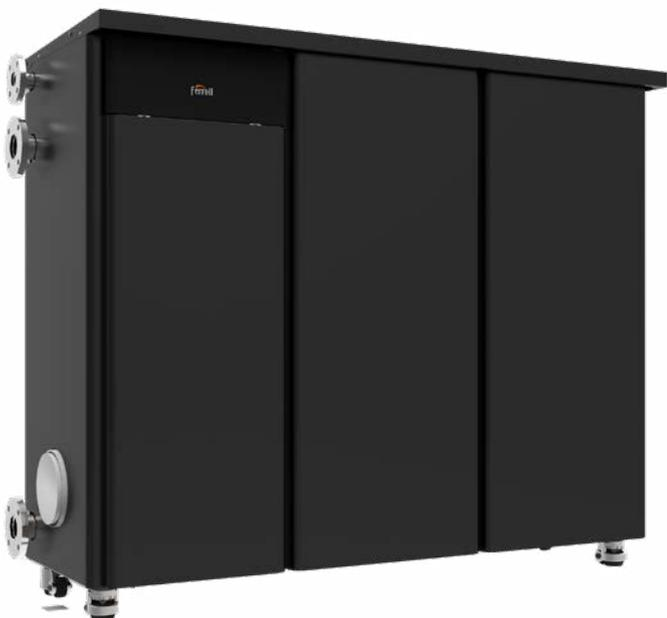
**Caldera de condensación con elevado rango de modulación de hasta 1:40. Permite una gran flexibilidad de utilización al disponer de cuerpos, bombas y quemadores independientes por cada módulo de 75 kW.**
